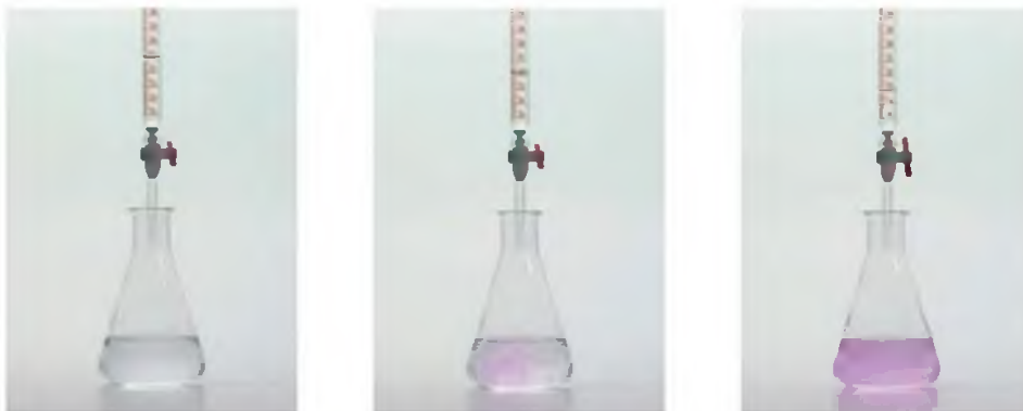
FIGURA 8.6 Valoración de un ácido. Un volumen conocido de un ácido se coloca en un matraz de Erlenmeyer con un indicador y se valora con un volumen medido de base, como el NaOH, hasta el punto de neutralización.
