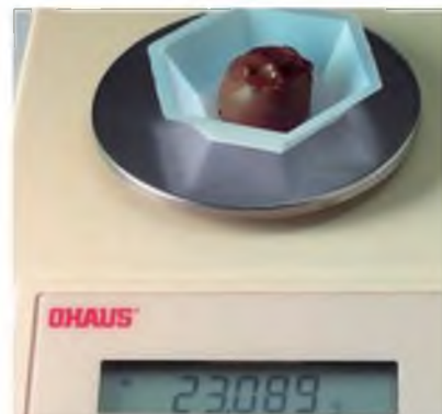
FIGURA 1.3 En la pantalla digital de esta balanza electrónica la masa aparece en gramos.
